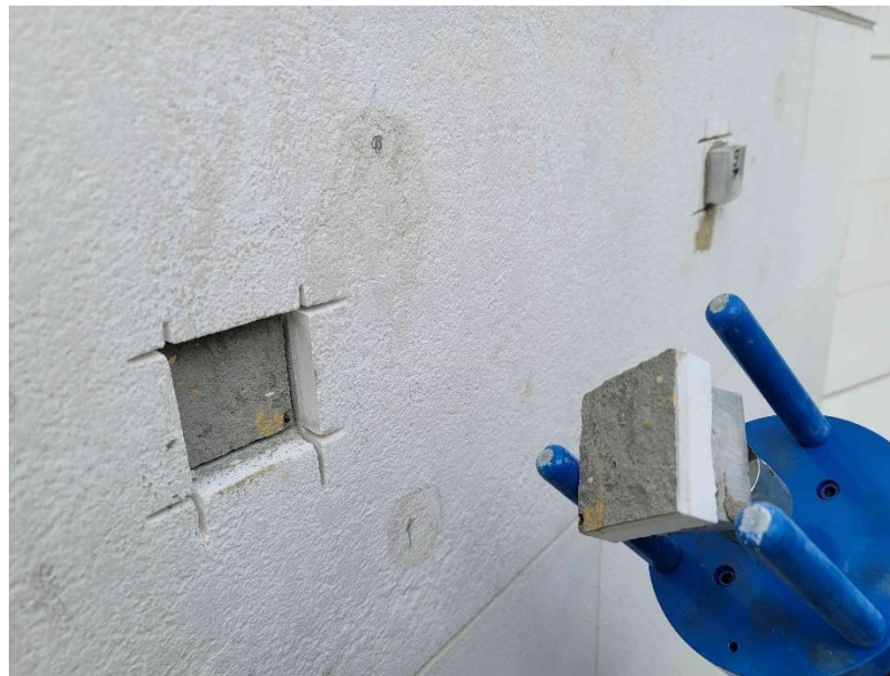
Imagen 73. Detalle de una de las probetas una vez se produjo la falla a tracción
