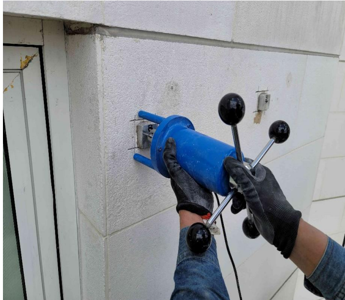
Imagen 72. Vista del equipo usado para las pruebas de tracción directa
