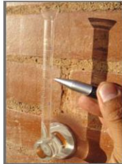
Imagen 76. Detalle de un ensayo con pipeta de Karsten sobre un muro de ladrillo antes de hidrofugar para conocer su absorción de agua.
