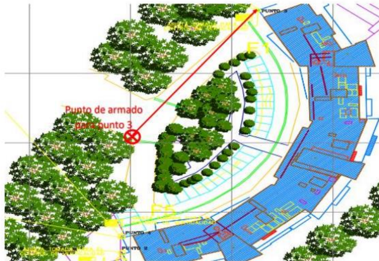
Imagen 84. Punto 3 de armado para medición de verticalidad en el costado oriental - costado norte.
