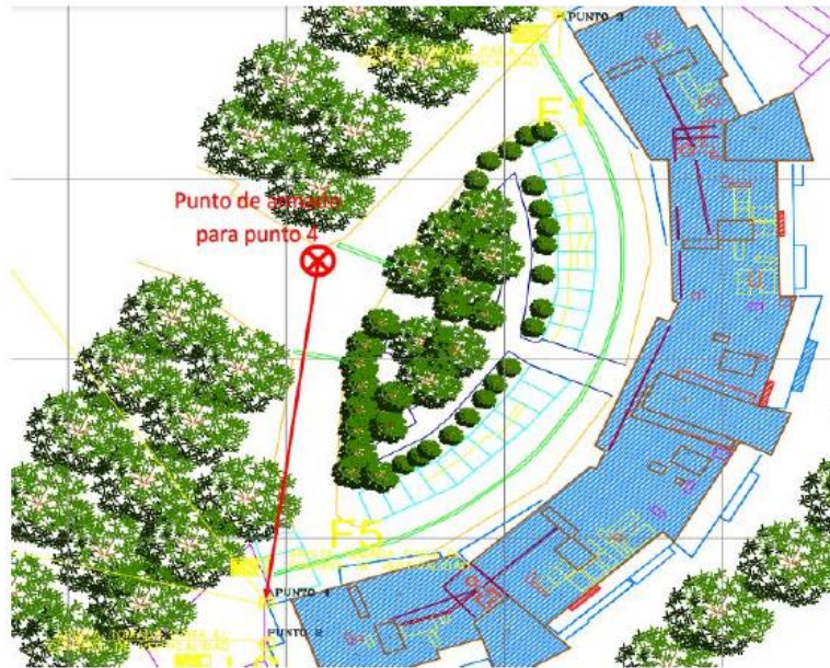
Imagen 85. Punto 4 de armado para la medición de verticalidad en el costado oriental - costado norte.
