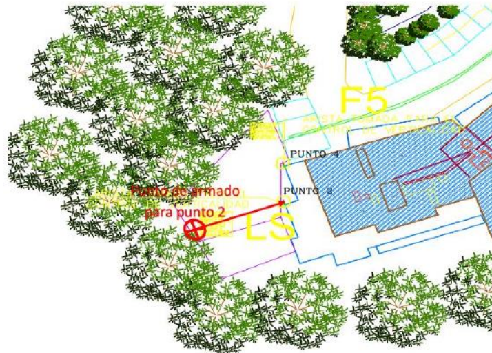
Imagen 83. Punto dos de armado para la medición de verticalidad en el costado sur.
