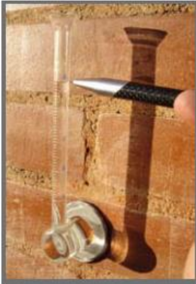
Imagen 76. Detalle de un ensayo con pipeta de Karsten sobre un muro de ladrillo antes de hidrofugar para conocer su absorción de agua.
